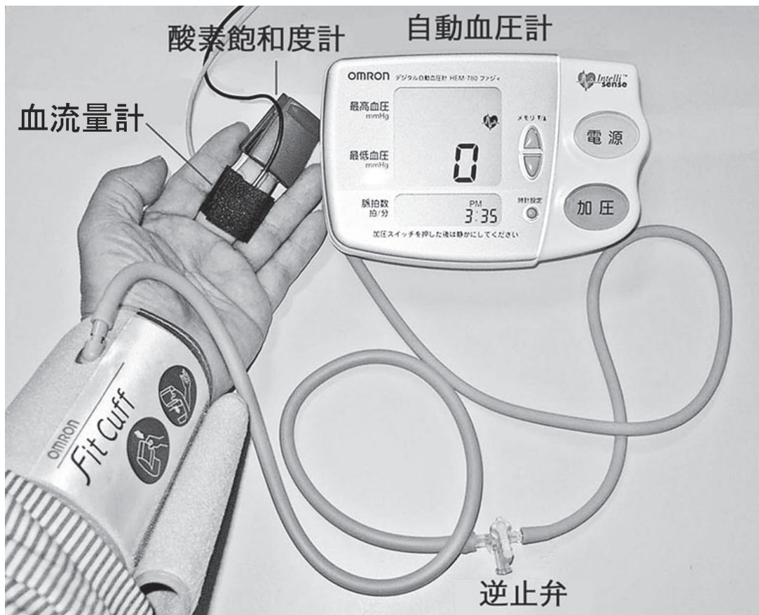
図5. 指先への血流を抑圧するために装着したカフと血圧計
