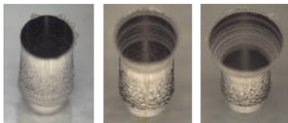
図 2-2 ガラス穴加工後の形状
